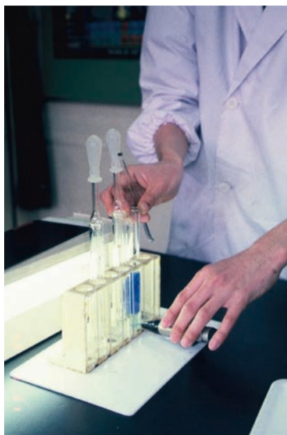
図1 感光器を用いて試験管内の液体の明度変化を調べる様子（鳥山先生提供）
